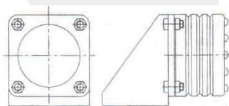
图 6 聚氨酯缓冲器 Polyurethane buffer
